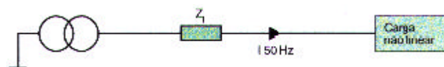
Fig. 8: esquema de uma instalação alimentando uma carga não-linear, para a qual só consideramos os fenômenos ligados a frequência 60 Hz (frequência fundamental).
