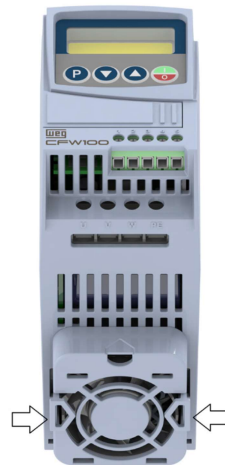
(b) Press the locks to release the fan bracket (b) Presione las trabas para liberación del soporte del ventilador (b) Pressione as travas para liberação do suporte do ventilador
